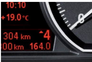
■ Indicatore del cambio di marcia : indica, sulle vetture con cambio manuale a 6 rapporti, il momento più favorevole, dal punto di vista dei consumi, per cambiare la marcia. Il sistema dà solo dei suggerimenti per il cambio di marcia, adattandoli al vostro stile di guida.
