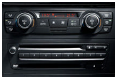
Climatizzatore automatico bi-zona con AUC. (Nella foto in abbinamento ai tasti memoria programmabili, solo in abbinamento ai sistemi di navigazione)
