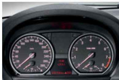
■ Quadro strumenti con indicatori analogici ed illuminazione passante rossa, tachimetro, display LCD per contachilometri totale e parziale, computer di bordo e contagiri con indicatore del livello carburante.
