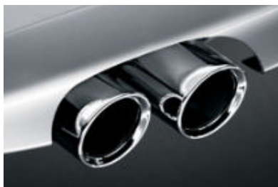
■ Doppio terminale di scarico: la 130i ha di serie il doppio terminale di scarico in acciaio cromato.
