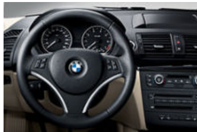
□ Volante sportivo in pelle con multifunzione (diametro 369 mm) a tre razze, con tasti multifunzione per i comandi della radio o del telefono. Di serie per la versione Futura.
