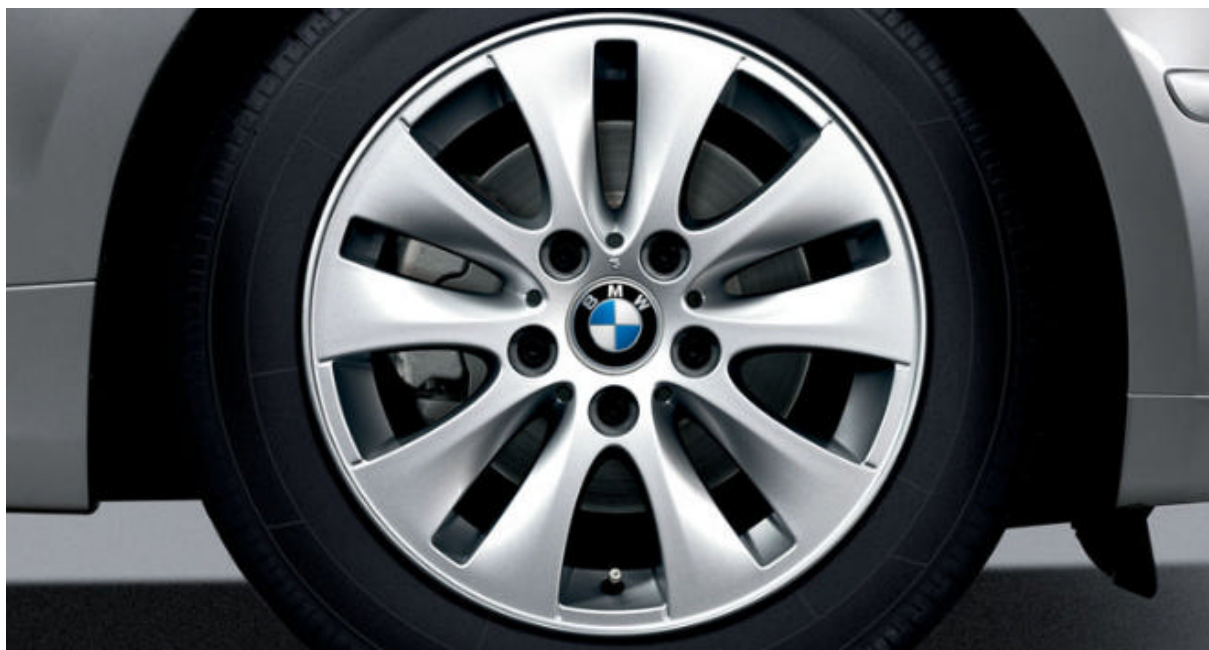
Cerchi in lega leggera BMW , styling a raggi a V n° 229, da 7 J x 16", con pneumatici 205/55 R 16 (di serie solo per 120i e 120d).
