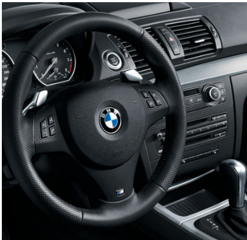
□ Comandi al volante «Paddles» posti sul volante: in abbinamento con il cambio automatico a 6 marce consentono di selezionare rapidamente il rapporto di cambio senza schiacciare la frizione.
