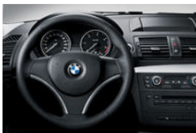
Volante sportivo in pelle (con diametro di 369 mm), a tre razze (di serie per 130i).
