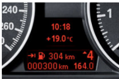
■ Computer di bordo : indica la velocità media, il consumo medio e quello del momento, l'autonomia e la temperatura esterna.
