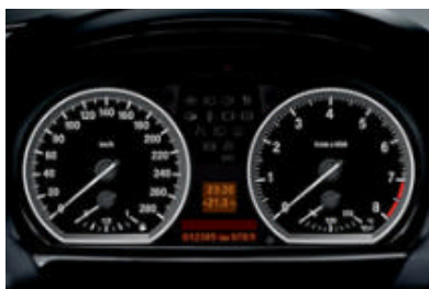
■ Il quadro strumenti della 130i presenta scale speciali con campi d'indicazione ampliati.
